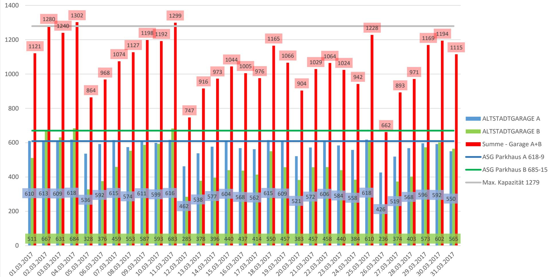
Die Ampeln bei den Einfahrten schalten jeweils bei 609 (A) bzw. 670 (B) auf ROT, um für die Dauerparker eine Reserve zu haben; d.h. die Garage ist mit 1279 Autos besetzt.
